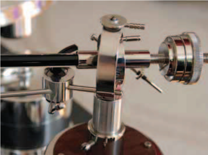
Bild 7: Detail des Tonarmlifts
